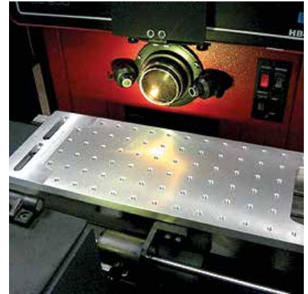
Messprojektor, Paletten und Anschlussleiste Measuring projector, pallet and docking rail
